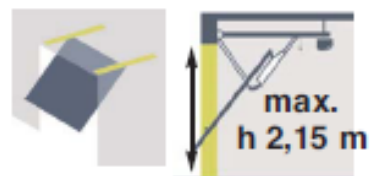
Vrata přesahující zárubeň
