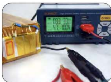
Měření 13S 48V 18650 bateriového
