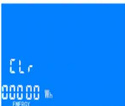
Obr. 9 Rozhraní vymazání stavu energie
