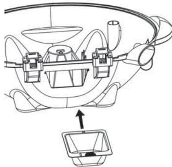
9. Do základny grilu A⑨ vložte grilovací desku A⑤ tak, aby zdička A③ byla umístěna v otvoru A⑦ a grilovací deska A⑤ spočívala v horizontální poloze.
