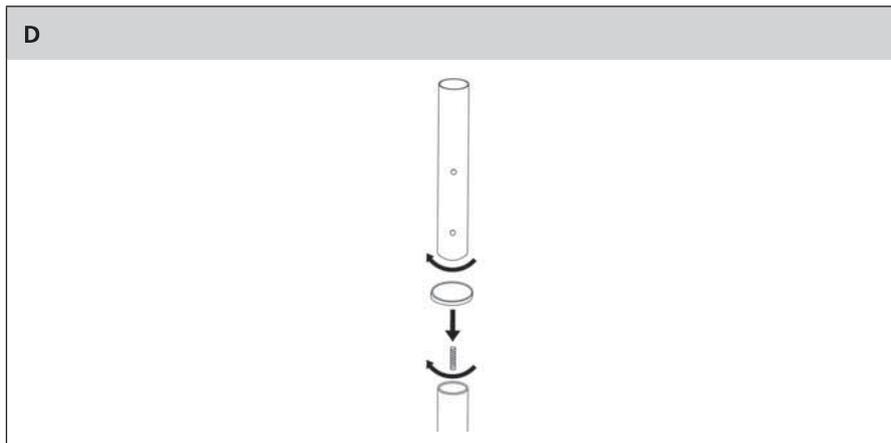
5. Volný konec spodní trubky A<sup>14</sup> zasuněte do středového otvoru v základně stojanu A<sup>10</sup>.
