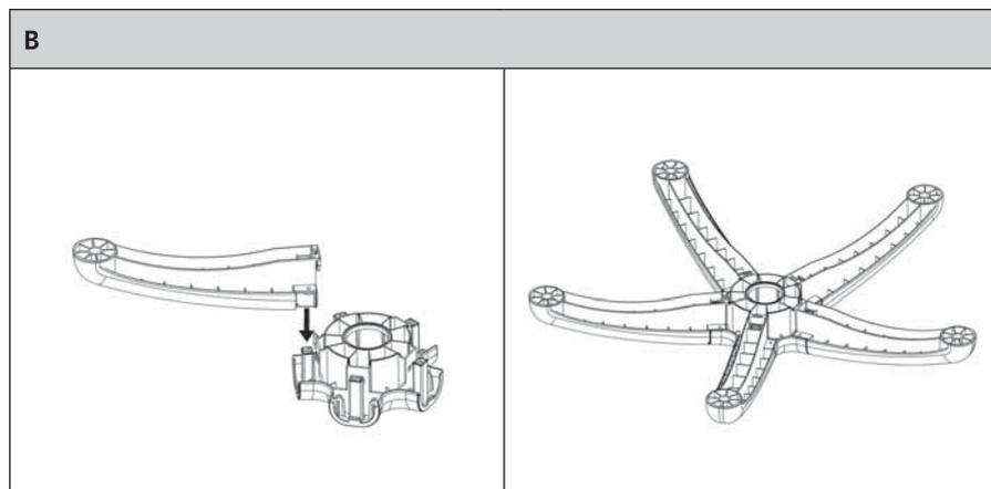
3. Na spodní stranu základny stojanu A<sup>15</sup> umístěte kovovou podložku A<sup>17</sup>. Spojení základny A<sup>15</sup> a nohou stojanu A<sup>16</sup> zajistěte dodanými šroubky (celkem 5 ks). Základnu A<sup>15</sup> otočte tak, aby podložka A<sup>17</sup> byla umístěna na spodní straně, a umístěte ji na rovný a stabilní povrch.
